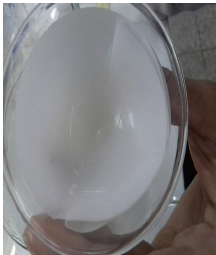
Gambar V.4 Penyaringan gel litium silika dengan kertas saring Whatman
