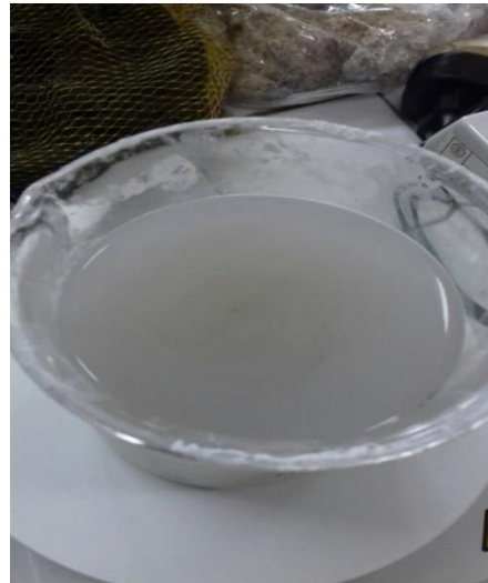
Gambar V.3 Larutan litium silika hasil pemanasan 70 °C
