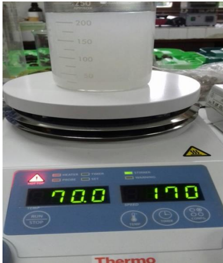
Gambar V.2 Pemanasan dan stirrer litium silika
